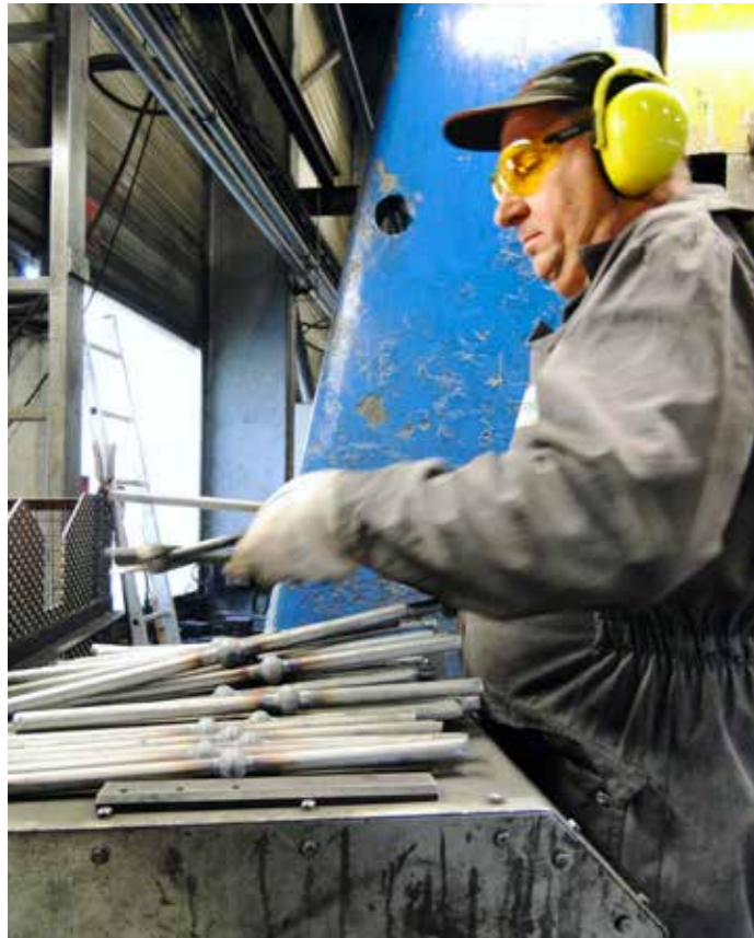
Protégé du bruit et de la fureur des machines, le forger saisit « les lopins » pour les glisser dans le marteau-pilon. Assouplis par la chaleur, les cylindres de métal commencent à prendre corps.
