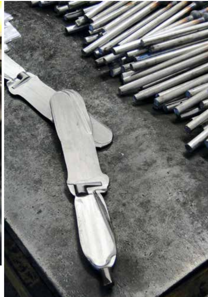
Protégé du bruit et de la fureur des machines, le forger saisit « les lopins » pour les glisser dans le marteau-pilon. Assouplis par la chaleur, les cylindres de métal commencent à prendre corps.
