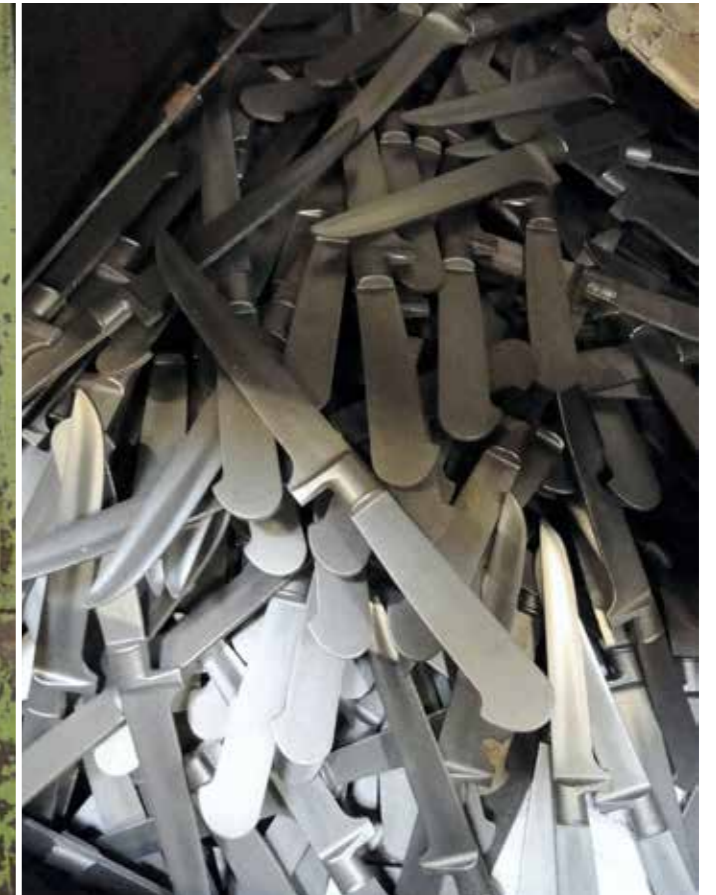
La longue marche du couteau : de la forge Arno aux ateliers Rousselon Sabatier à Thiers... Le 100 % forgé prend tout son sens dans cette masse métallique brute qui a déjà la forme exacte du modèle à venir. La trempe lui donne sa dureté. Le meulage (page suivante) lui apportera le tranchant indispensable. Lionel Sol, qui partage la direction de l'entreprise avec son épouse, défend la marque avec passion.
