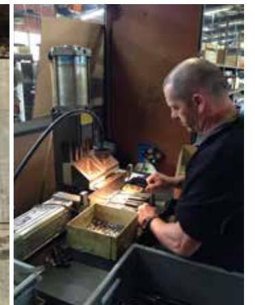
La longue marche du couteau : de la forge Arno aux ateliers Rousselon Sabatier à Thiers... Le 100 % forgé prend tout son sens dans cette masse métallique brute qui a déjà la forme exacte du modèle à venir. La trempe lui donne sa dureté. Le meulage (page suivante) lui apportera le tranchant indispensable. Lionel Sol, qui partage la direction de l'entreprise avec son épouse, défend la marque avec passion.
